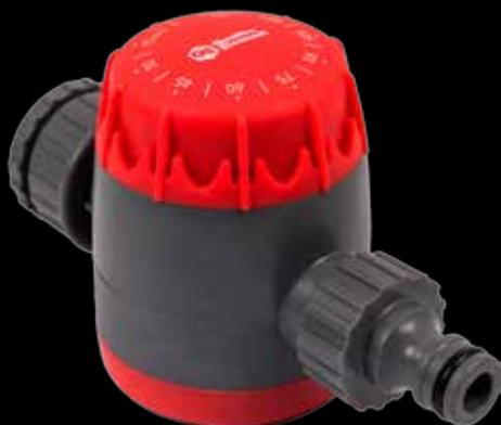
Предназначен для использования в системах автоматического полива и орошения. Особенно удобен для капельного полива в теплицах. Время можно изменять плавно в пределах от 0 до 120 минут. Оснащен штуцером для подключения гибкого шланга с быстроразъемным соединителем, с другой стороны расположено резьбовое соединение на  $\frac{3}{4}$ " с фторкой на  $\frac{1}{2}$ "
