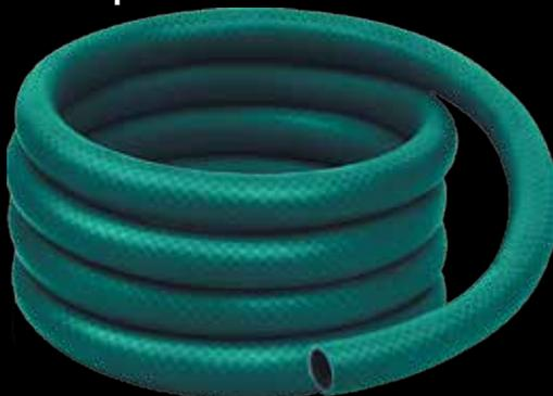
Гибкий и высокопрочный садовый шланг, изготовлен из высококачественного первичного ПВХ. Крестовое армирование прочной полиэстеровой нитью. Рабочее давление до 6 атмосфер.
