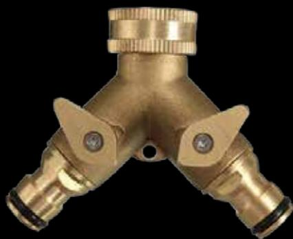
Предназначен для разветвления потока воды на два направления, обычно устанавливается стационарно на трубу с помощью резьбового соединения. Оснащен футоркой для перехода на меньшую резьбу. Подключение шлангов с помощью быстроразъемных соединителей. С помощью переключателей можно включать или выключать один или оба канала разветвления.
